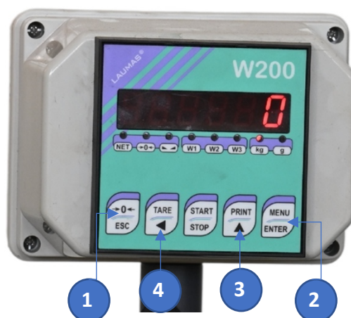
Рис. 11. Контроллер контрольных весов
